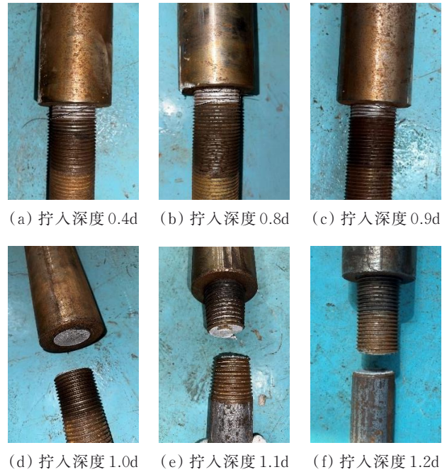
图5 不同拧入深度试件破坏形态
