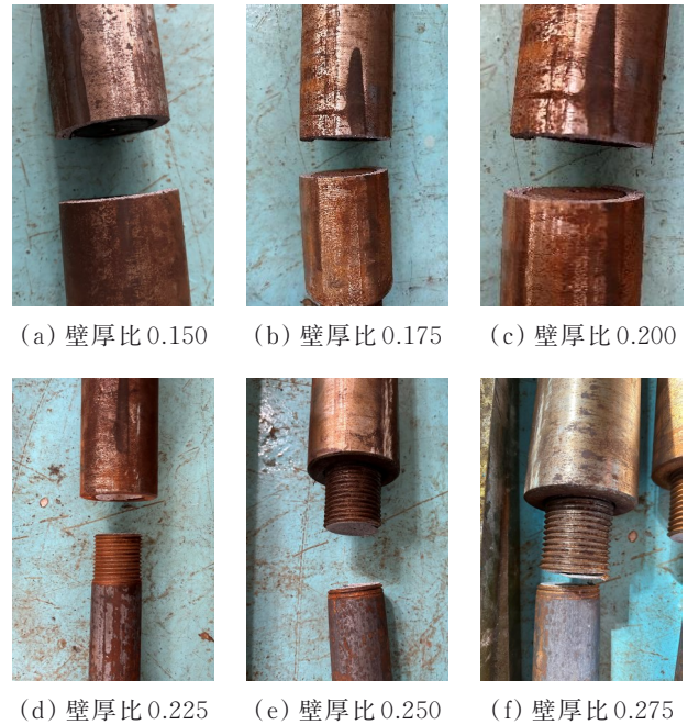
图8 不同套筒壁厚试件破坏形态
